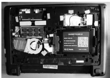
Figura 10. Un ordinador portàtil amb obertura fàcil i accés immediat als components. Font: elaboració pròpia
